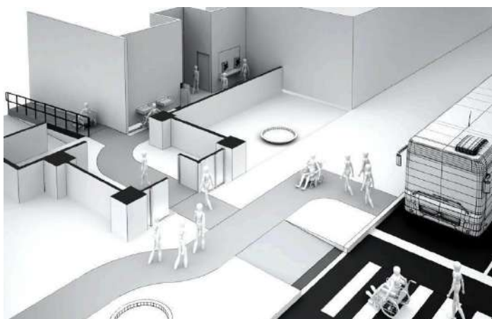
Perspectiva: Representación de una ruta accesible en edificación y conectada con el espacio público adyacente.
