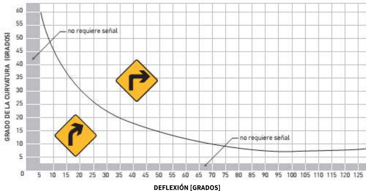
IMAGEN 5.7 USO DE LAS SEÑALES PREVENTIVAS SP-6 CURVA Y SP-7 CODO
