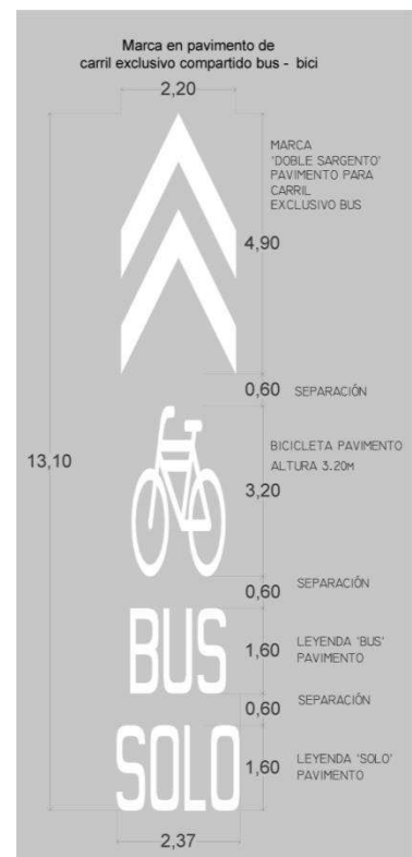
M-11.2c Marca para indicar carril exclusivo para transporte público y vehículos no motorizados
