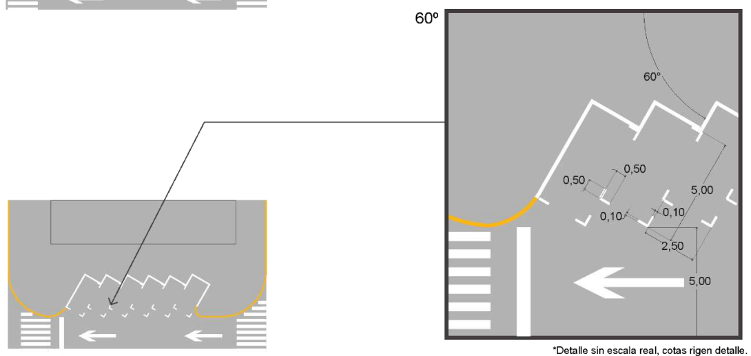
M-10.2b Rayas para estacionamiento en batería con ángulos menores a 90° (30°, 45°, 60°)
