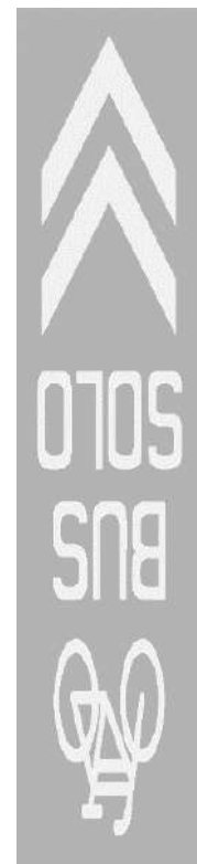
M-11.2d Marca para indicar carril exclusivo para transporte público y vehículos no motorizados
