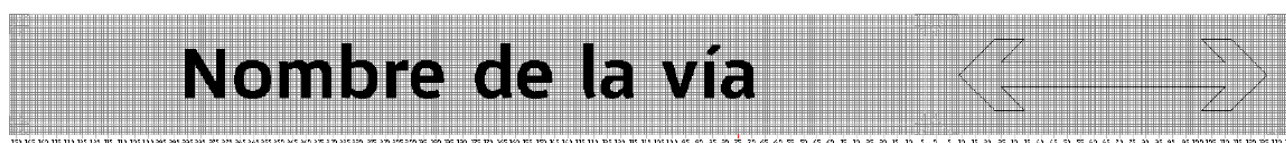
IMAGEN 7.14 TRAZO EN RETÍCULA DE LA SEÑAL INFORMATIVA DE IDENTIFICACIÓN SII-6d.2. Nomenclatura elevada en bandera
