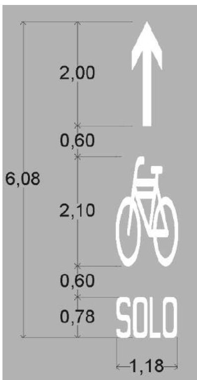
M-11.2 Marca en pavimento de carril exclusivo de bicicletas
